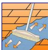
Eine saubere, klare Oberfläche erhalten Sie durch Reinigen mit Lithofin MN Zementschleierentferner. Sie entfernen Sie gleichzeitig Zementschleier und anderen Bauschmutz. Den Reiniger verdünnen Sie bis ca. 1:7, auf die vorgeässte Fläche auftragen, nach wenigen Minuten durchbürsten und anschließend mit reichlich Wasser abspülen.
