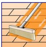
Verarbeitung: Einfach mit Flächenpinsel, Versiegelungsbürste oder Rolle satt und gleichmäßig auftragen, einziehen lassen und Überschuss vor dem Antrocknen (ca. 15 Min.) restlos entfernen.
