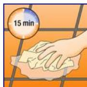
Überschuss, Streifen, Pfützen verteilen oder vollständig entfernen
